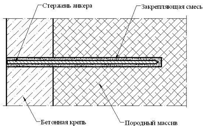
Рис. 3 - Схема установки анкера через монолитную бетонную крепь
